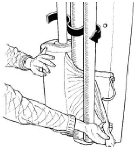
Fig. 6.3. Comment installer le film sur le distributeur
